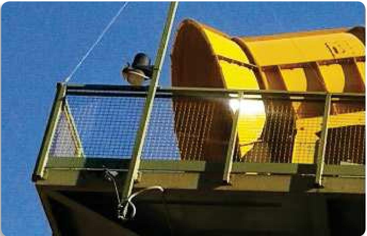
Al sistema di abbattimento può essere integrato un sistema meteorologico per la rilevazione della velocità e della direzione del vento in modo da poter programmare
