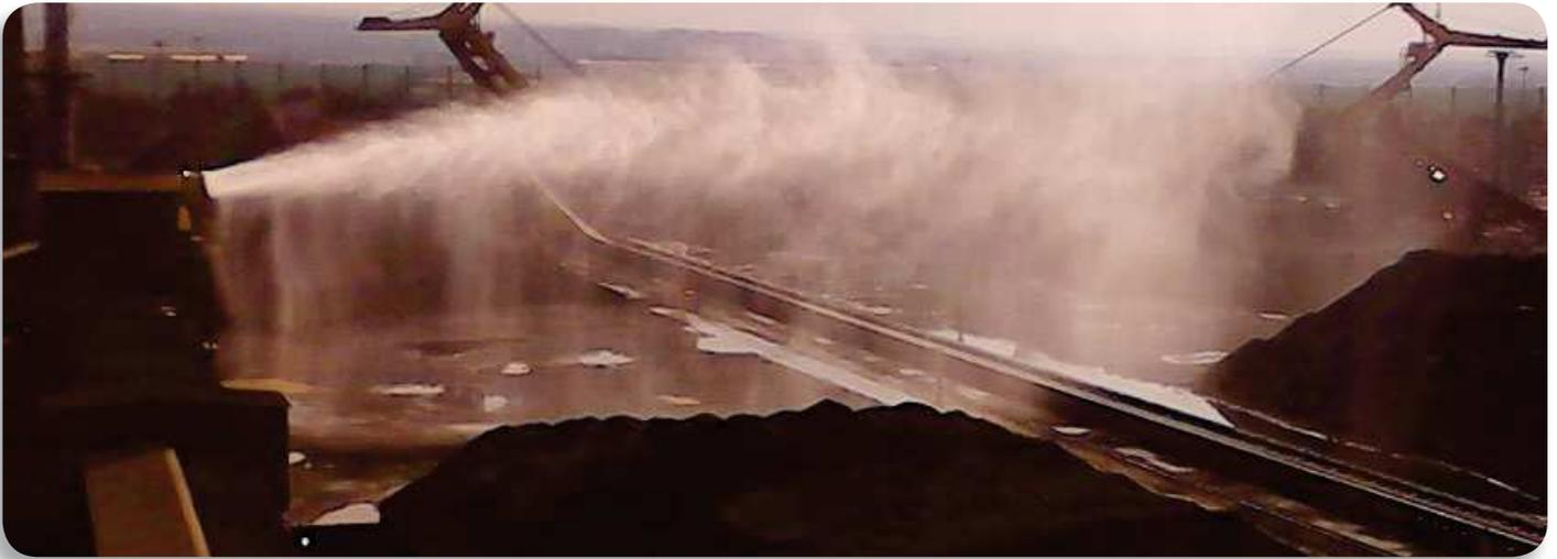
L'umidificazione che si ottiene con tali gocce di acqua, di dimensioni dell'ordine dei micron, permette la ricopertura del deposito sul solo strato superficiale creando un film
