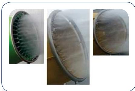
Nota la tipologia di area da coprire con la "nebbia" si sceglie il tipo di ugello ottimale in grado di generare gocce che "inglobino" la particella di inquinante. Il diametro delle gocce viene scelto in funzione della granulometria della polvere da abbattere.
